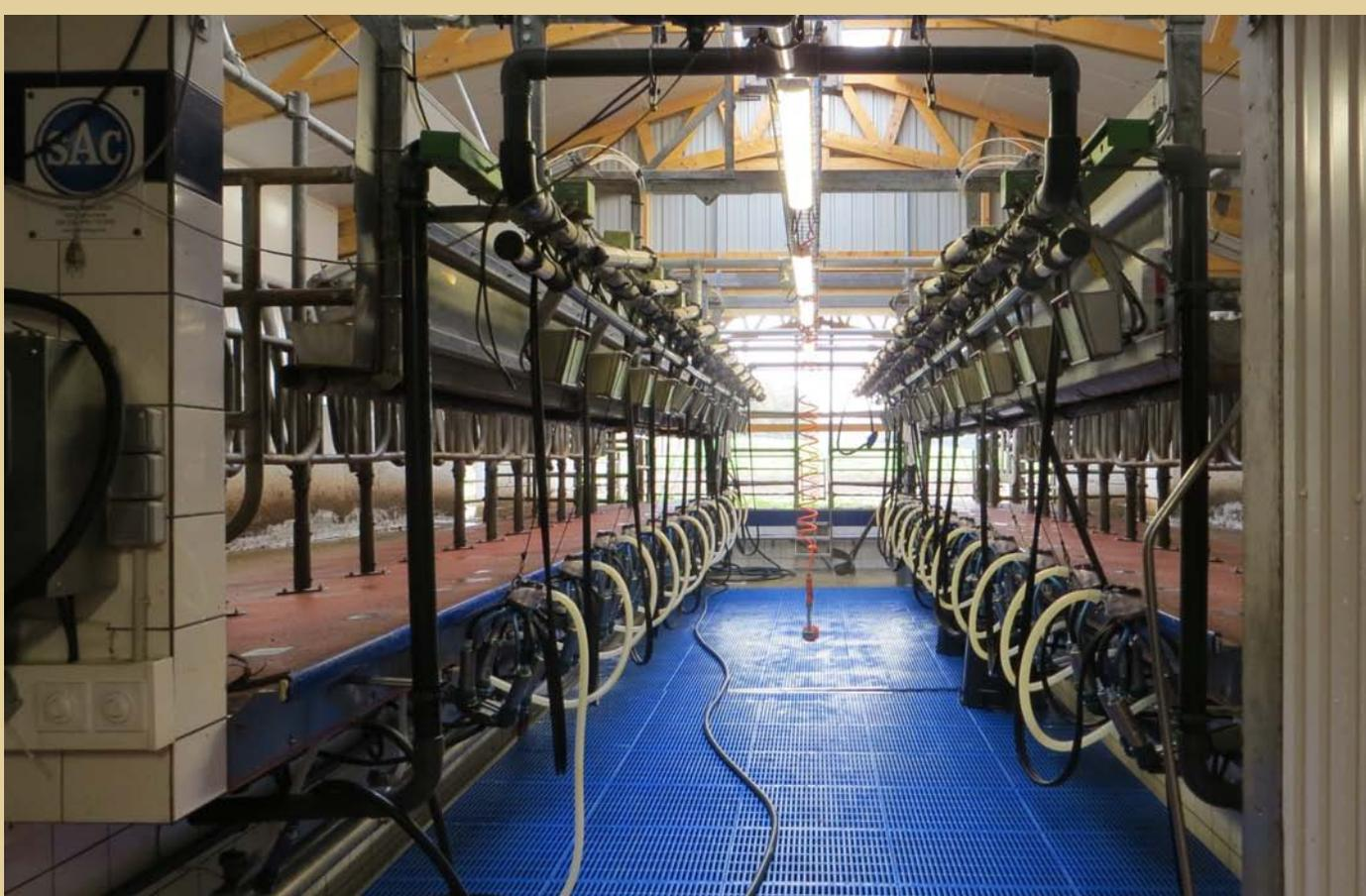
La salle de traite TPA 2x12 est indépendante de la stabulation. Pour le confort des vaches et des trayeurs, la toiture est isolée, la hauteur des quais réglables. Les mamelles sont rétroéclairées pour une bonne visibilité.
