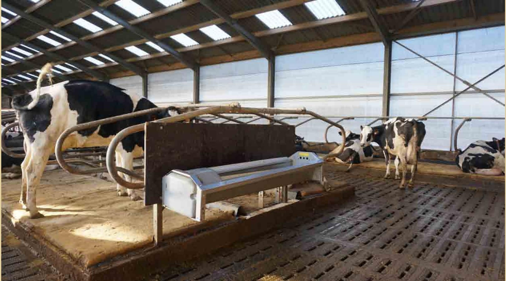
Le confort des vaches est assuré par les matelas des logettes, les caillebotis caoutchouc, les grands abreuvoirs à disposition, un rideau réglable sur toute la hauteur devant les logettes et beaucoup de luminosité
