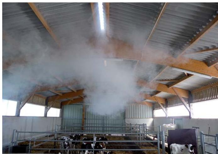
Observation du circuit d'air par fumigène
