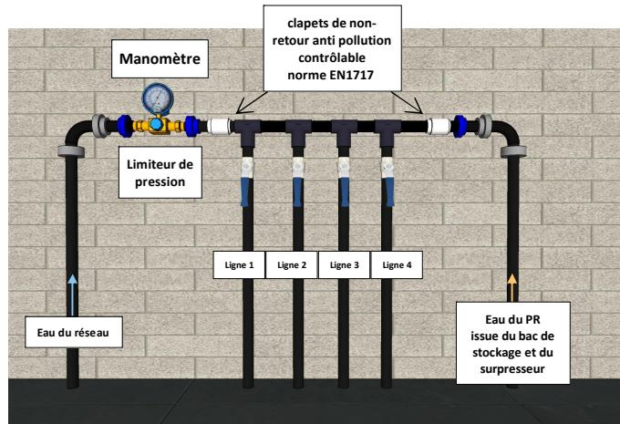
Schéma de distribution de l'abreuvement avec l'eau du pré-refroidisseur, dans le cas d'une utilisation sous pression vers plusieurs lignes d'abreuvoirs.
