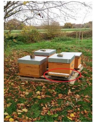
*Photo d'une ruche équipée d'une balance électronique*
