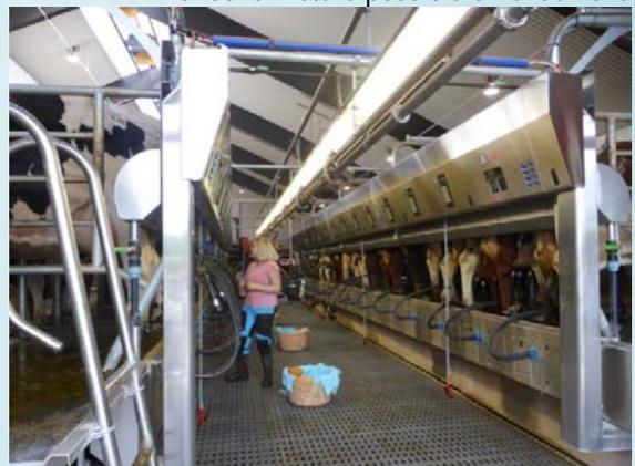
Salle de traite TPA 2x16 postes sortie rapide avec plancher mobile
