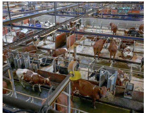
Les robots d'alimentation et les racleurs permettent une organisation spatiale différente ne nécessitant et ne permettant aucun accès aux tracteurs.
