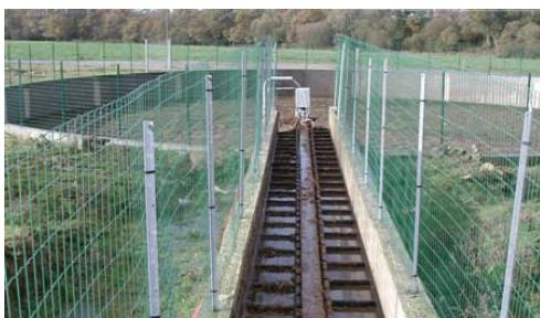
Utiliser un évacuateur permet de reprendre les fumiers ou les lisiers pailleux dans un canal de faible largeur. Comme les racleurs, il peut être hydraulique ou électrique.
