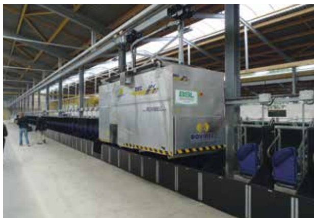
Photo 7.1 : L'automate DEC de Rovibec est ici suspendu sur un rail fixé sur la charpente
