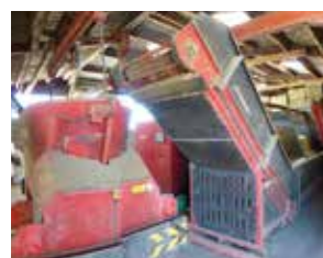
Photo 5.14 : Automate Trioliet qui effectue le mélange et la distribution
