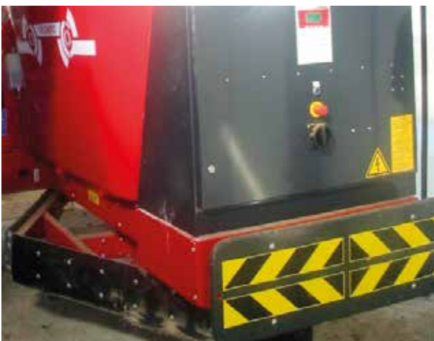
Photo 14.11 : Pare-chocs frontaux/barre anticollision (arrêtent la machine au premier contact)
