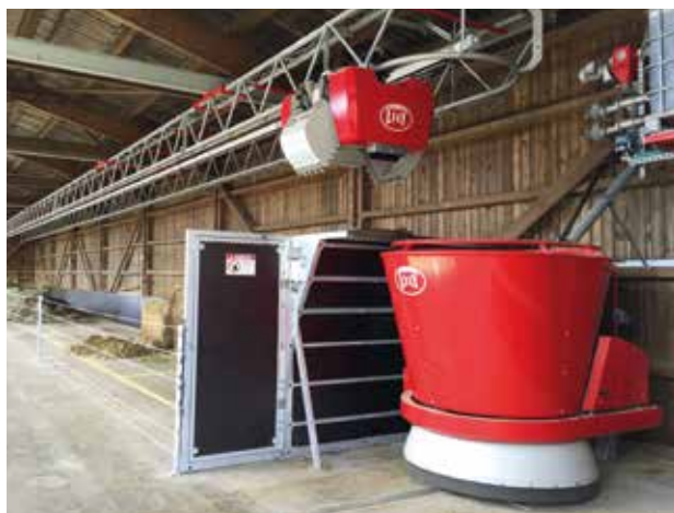
Photo 6.6 : Cuisine Lely disposée en longueur avec fourrages entreposés au sol
