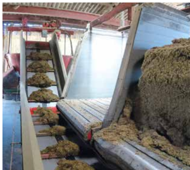
Photo 6.8 : Convoyeur disposé à l'arrière des tables Trioliet pour acheminer le fourrage vers la mélangeuse fixe
