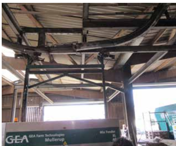
Photo 7.5 : Les automates sur rail nécessitent parfois des aiguillages pour changer de circuit
