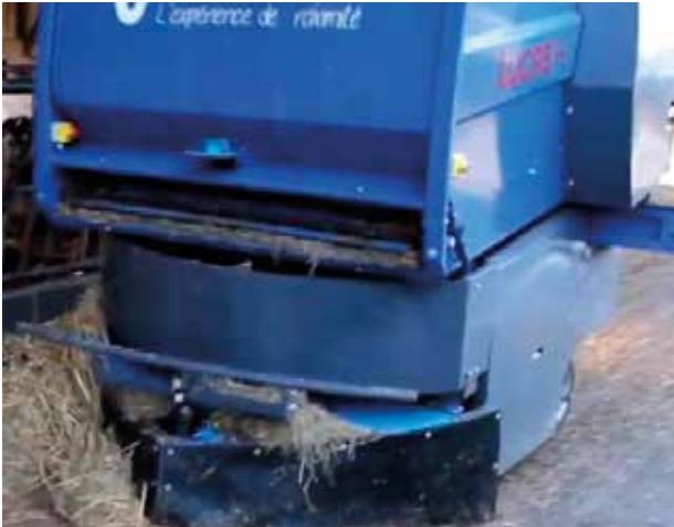
Photo 14.10 : Capteurs de détection d'obstacles
