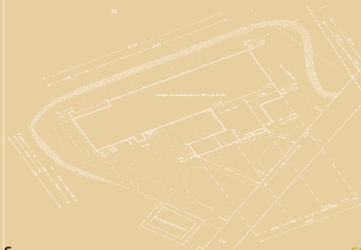
L'implantation le long des courbes de niveaux permet de limiter le terrassement et de protéger par le déblai la façade ouverte du bâtiment orientée sud.
