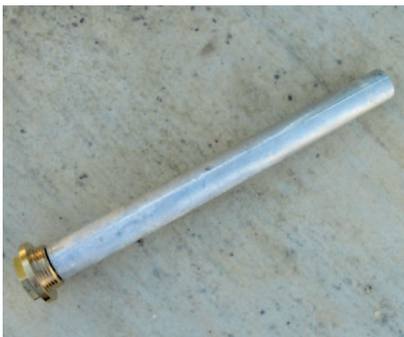
L'anode sacrificielle se corrode dans le temps et doit être changée à intervalle régulier en fonction de la qualité de l'eau
