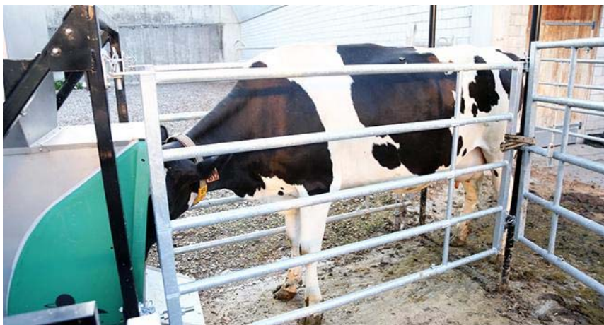
Analyse en direct du CH 4 entérique – GreenFeed. / INRA © cultivar Elevage
