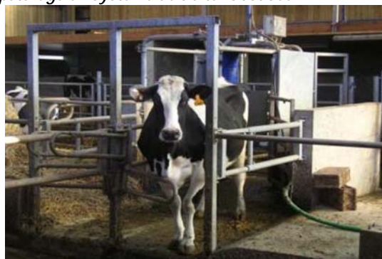
Porte de tri trois voies commandée par les puces RFID
